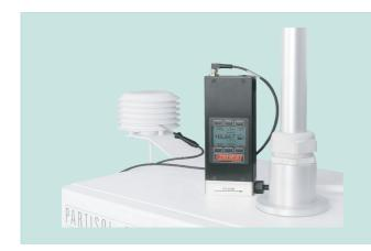
美国 ALICAT 66 系列手持式大气采样流量校准仪,采用内部补偿型层 流压差技术, 使得大流量范围下气体仍旧保持层流运动。内置大气压 传感器和外置温度探头对当前大气压和环境温度进行精确瞬间测量, 专门针对环保法规要求设计。所有产品均具有 NIST 可溯源校准证书。 ALICAT 66 系列手持式大气采样流量校准仪,可现场显示当前大气压、 温度、湿度、体积流量和质量流量, 主要用于大气颗粒物校准仪采集 器流量的定期校准,方便快捷。
